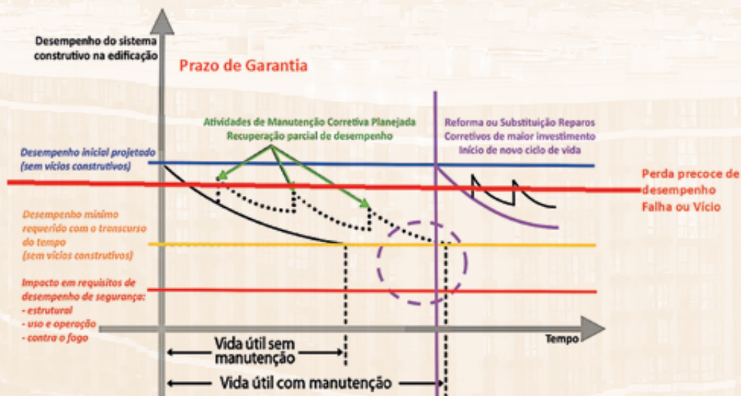
Gráfico 1: Desempenho versus tempo de uso do sistema construtivo, adaptado da ABNT NBR 15575-1
