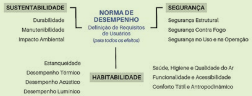
Figura 1: os três conjuntos de requisitos do usuário definidos pela NBR 15575-1 (ABNT, 2024)
