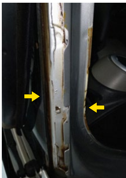
Detalhe de corte na coluna à esquerda
