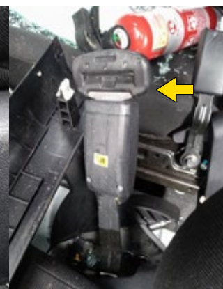
Fivela fixada na trava
