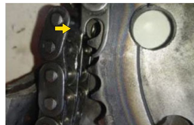
Detalhe do local de rompimento na corrente
